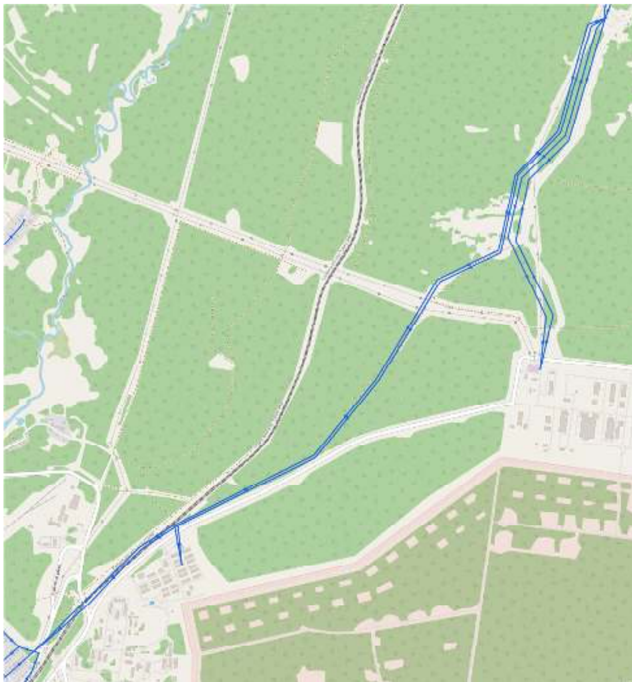
Рисунок 21 - Технологическая зона водоснабжения п. Кизнер (насосная станция 3-его подъема – Потребители Кизнерского ТО)
