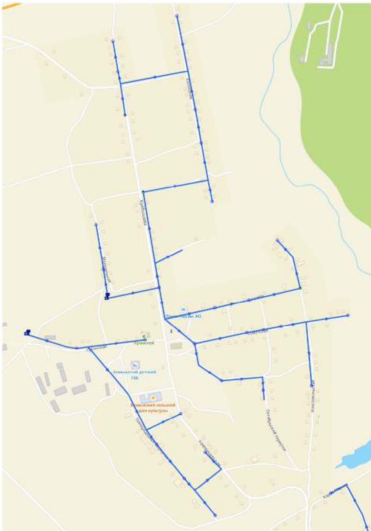
Рисунок 10 - Технологическая зона водоснабжения с. Бемыж (север)
