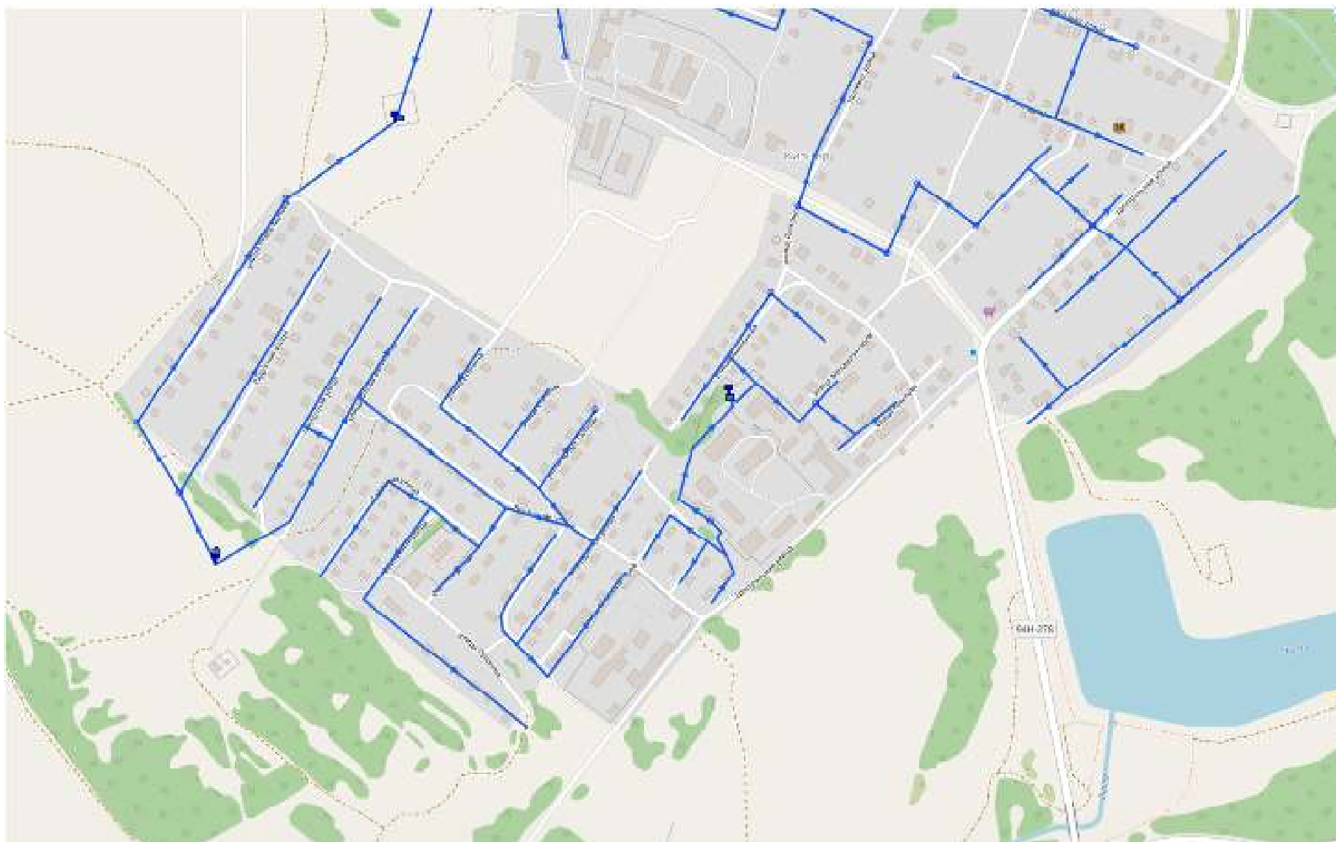
Рисунок 33 - Технологическая зона водоснабжения с. Кизнер (юг)
